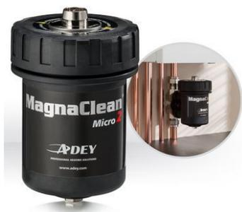
Filtre compact pour chauffage central domestique, protège les installations de chauffage central contre les dégâts causés par les boues et les dépôts. Installation horizontale et verticale jusqu'à 8 radiateurs. Température maximale de fonctionnement : 95°C. Pression maximale de fonctionnement : 6 bar. Hauteur minimale d'installation : 191 mm. Débit maximal : 50 L/min (3m<sup>3</sup>/h).
