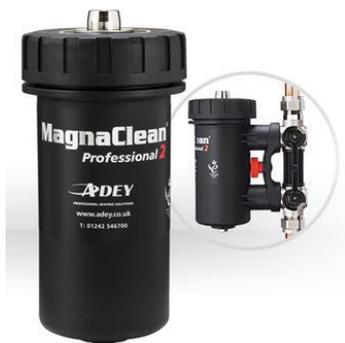
Filtre pour chauffage central domestique ou pompe à chaleur, protège les installations contre les dégâts causés par les boues et les dépôts. Installation horizontale et verticale pour de 8 à 16 radiateurs. Température maximale de fonctionnement : 95°C. Pression maximale de fonctionnement : 6 bar. Hauteur minimale d'installation : 244 mm. Débit maximal : 50 L/min (3m<sup>3</sup>/h).
