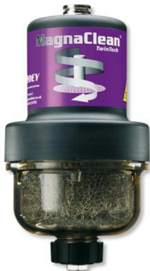
Filtre pour chauffage central domestique ou pompe à chaleur. MagnaClean TwinTech a été plus spécialement développé pour protéger les circuits de chauffage individuels fonctionnant avec des radiateurs basse température et/ou des planchers chauffant. Température maximale de fonctionnement: 95°C. Pression maximale de fonctionnement : 6 bar. Débit maximal : 50 L/min (3m<sup>3</sup>/h).
