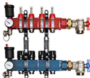
Ensemble de collecteurs en matériaux de synthèse, livrés pré-montés avec leur équipement complet, testés en usine à 10 bars. Diamètre des collecteurs Ø 1" sorties circuits Ø 3/4" eurocône. Possibilité de raccordement indifféremment par la droite ou par la gauche. Esthétique moderne, aspect soigné.
