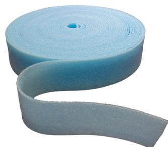
Permet de désolidariser la chape de toutes les parois verticales et évite ainsi les ponts thermiques en périphérie de pièce. Modèle simple. Épaisseur 5 mm. Rouleau de 50 m.
