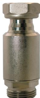
En acier inoxydable, cette vanne anti-condensation pour collecteur de plancher chauffant se fixe sur le collecteur de départ et évite la condensation dans les pièces humides (salle de bain, cuisine, wc...) en phase de rafraîchissement du plancher. Débit : 2100 l/h. Pression de service : 10 bars. Pour collecteur Cosypack Finimétal.
