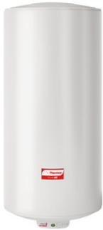
Double entraxe : Remplace tous les chauffe-eau verticaux muraux. Dure jusqu'à deux fois plus longtemps : Résistance stéatite anticalcaire insérée dans un fourreau, sans contact direct avec l'eau. En cas de remplacement, pas besoin de vidange. Double protection anticorrosion : Anode en titane inusable enrobée de magnésium, pas d'entretien de l'anode. Livré avec raccord diélectrique.
