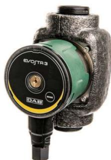
Plage de fonctionnement : 0,4-4,2 m<sup>3</sup> /h avec hauteurs manométriques jusqu'à 8 m. Plage de températures du liquide : de -10 °C à +110 °C. Pression de service maximum : 10 bar (1000 kPa). Niveau de protection : IPX5. Classe d'isolation : F. Vis de dégommage. Entraxe 180 mm. Avec coquille d'isolation thermique de série.
