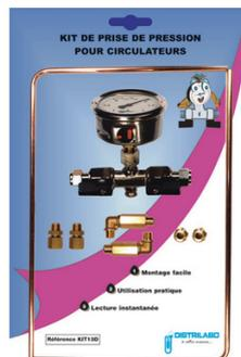
Kit de prise de pression universel comprenant : 1 manomètre boîtier inox 0/6 bar Classe 1.6 à bain de glycérine, 1 robinet d'isolement 1/4 tour multifonction avec purge intégrée. Des rallonges de montage. Des tubes de liaison Cu 4/6 cintrés. Raccords laiton 1/4" et 1/8".
