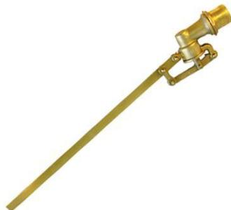
Température d'utilisation : 0° à 80°C - Pression PN5 bars - Raccordement gaz mâle ISO 228-1 BSPP - Corps et siège en laiton - Etanchéité clapet NBR - Tige inox.
