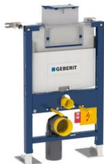
Bâti-support Duofix Omega 12 cm, hauteur 82 cm, autoportant. Ce bâti-support permet l'installation d'un WC suspendu sous les combles ou sous une fenêtre. Capacité plage de réglage : 3 - 7.5 l. Entraxe cuvette : 180 - 230 mm. Profondeur x Largeur x Hauteur : 170 x 500 x 820 mm. Plaque omega obligatoire 111.009.00.1.
