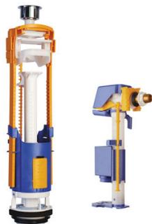
Robinet flotteur à remplissage différé, certifié NF classe acoustique 1, très silencieux, alimentation latérale 12x17 en laiton, fermeture hydraulique, niveau d'eau réglable, compact, remplissage rapide 0.15 l / sec à 3 bars.
