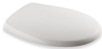
Abattant de WC en Polypropylène incassable. Poids 1,250 Kg, dimensions: L 440 mm, l 370 mm. Angle d'ouverture 108°. Adapté à toute cuvette normalisée avec entraxe de fixation compris entre 130 et 180 mm.
