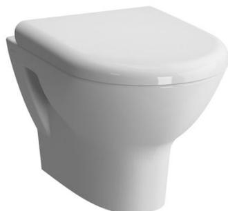
Cuvette suspendue murale à fond creux. Capacité de chasse d'eau 3/6 L. Abattant soft close, duroplast et hygiénique. Fixation par le haut. Dimensions : 50 x 35,5 cm.
