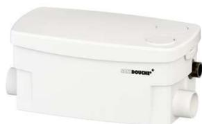
Pompe adaptée pour receveur de douche classique. 2 entrées latérales basses. Enclenchement bas. Alimentation : 220-240 V / 50-60 Hz. Diamètre de refoulement : 32 mm. Refoulement vertical max : 5 m. Refoulement horizontal max : 50 m. Température moyenne des eaux admissibles : 35°C. Dimensions : 359 x 166 x 213 mm. Clapet anti-retour, connecteurs et filtre à charbon actif inclus.
