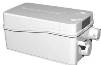
Pompe compacte des eaux grises des lavabos, cabines de douche ou bidets. Installation murale frontale ou dans un placard. Clapet anti-retour à battant intégré, soupape de ventilation à filtre à charbon et dispositif de trop-plein. Passage libre de 10 mm
