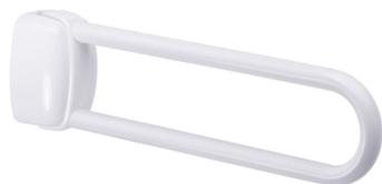
Tube Inox Ø 30 mm. Embase en résine de synthèse. Fixations invisibles. Blocage automatique en position horizontale ou verticale, utilisable dans les deux positions. Poteau de fixation vendu à part, avec étrier de fixation réglable en hauteur. Acier époxy blanc. Vendu seul.
