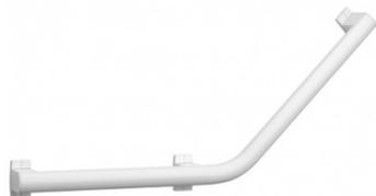
3 points de fixation, symétrique 400 x 400 mm. Tube elliptique 38 x 25 mm en aluminium blanc. Cache-fixations en résine de synthèse blancs. 3ème point à positionner pour version droite ou gauche. Visserie fournie.
