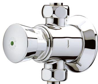
Avec raccords 12x14. Alimentation en ligne. Arrivée mâle 1/2" (15x21). Sortie droite ou équerre mâle 1/2" (15x21). Durée d'écoulement : 6 secondes ( $\pm$  2 secondes). Débit : 9l/mn à 1 bar (réglable par l'installateur en fonction de la pression). Réglage 4 positions. Livré avec : Joint plat et écrou raccord, Ecrou pour tube 12x14, Rosace solidaire du robinet.
