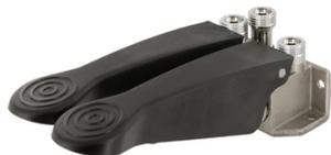
Débit d'utilisation 6 L/mn (réglable suivant pression). Durée d'écoulement suivant le temps d'appui du pied, suivi d'une fermeture lente. (évite les coups de bélier). Longueur hors tout 200 mm. Modèle 2 pédales : eau froide et eau chaude.
