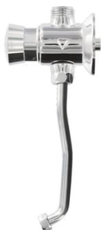
Le kit complet pour urinoir Jacob Delafon modèle Coquille 2 comprend: 1 robinet temporisé P12 NEO, 1 tube équipé 1/2", 1 joint plat, 2 écrous, 1 rosace solidaire du robinet. Débit: 9l/min. Ecoulement: 6 sec. Alimentation en ligne, M G1/2"
