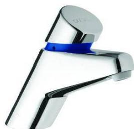
Pression d'utilisation recommandée : 1 à 5 bars. Débit : Limiteur de débit 4l/mn. Réglage interne 5 positions. Dispositif anti-coup de bétier Brise-jet : anti-vandalisme et anti-bouchage. Durée d'écoulement : 15 secondes  $\pm$  5 secondes. Réglable par bague 4 positions. Fonctionnement : Par simple pression sur le bouton (déclenchement souple). Alimentation hydraulique : Mâle G 1/2 (15x21) en eau froide (jupe bleue).
