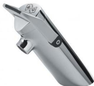
Robinet sur plage pour lavabo Presto NEO DUO. Déclenchement mécanique et temporisé par manette souple ergonomique adapté aux enfants. Double temporisation 7-11sec modifiable. Débit 3l/min. G1/2".
