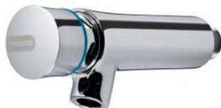
Simple pression sur le bouton-poussoir. L'eau s'arrête automatiquement après une temporisation réglée en usine fixe de 15 secondes. Avec réglage de débit 4 positions.
