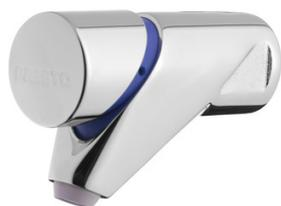
Modèle pour eau froide. La bague est de couleur bleue. Durée d'écoulement : 15 secondes  $\pm$  5 secondes réglable par bague 4 positions. Limiteur de débit 4l/mn. Bague de réglage 5 positions inaccessible par l'utilisateur. Dispositif anti-coup du bétier. Brise-jet : Anti-vandalisme et anti-bouchage. Filtre à gravier incorporé dans le module hydraulique.
