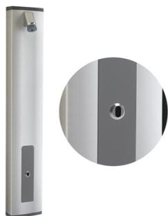
Panneau de douche électronique adapté PMR avec pomme fixe à picots anticalcaire. Pression de 1 à 5 bars pour 6 l/min à 3 bars par limiteur de débit intégré - 30 secondes par défaut réglable par PRESTOCOM. Dispositif anti-coup de bélier. Détection portée de 10 cm devant la cellule. Ouverture du panneau sans démontage et robinetteries sur platine amovible. Profilé aluminium anodisé (épaisseur 2,5 mm). Capots d'extrémité en ABS haute résistance RAL 7005.
