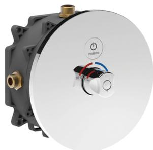
Pression de 1 à 5 bars avec 8 l/mn durée 30 secondes (réglable). Dispositif anti-coup de bélier. Déclenchement par bouton sensible PRESTO TOUCH adapté PMR. Limitation de la température maximale par butée réglable à l'intérieur du produit non accessible à l'utilisateur (Antibrûlure). Rinçage périodique de 30s toutes les 24h. Boîtier d'encastrement étanche.
