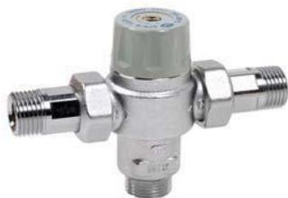
Avec manette graduée. Réglable par l'utilisateur. Différence mini. De température entre l'eau chaude et l'eau mitigée : 15 °C. Différence maxi. De pression entre l'eau chaude et l'eau froide : rapport 2:1. Température maxi. E. C. : 65 °C. NF.
