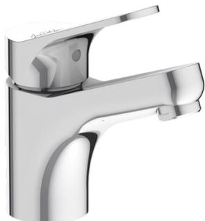
Hauteur totale du robinet : 136 mm. Hauteur sous aérateur : 80 mm. Saillie du bec : 103 mm. Raccords : Avec flexibles d'alimentation. Mécanisme : Cartouche à disques céramique. Débit limité à 5 l/mn. Hauteur totale 136 mm. Hauteur sous bec 80 mm. Saillie 103 mm.
