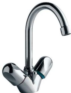
Mélangeur lavabo monotrou bec tube orientable. Hauteur : 227 mm. Hauteur sous bec : 149 mm. Saillie : 142 mm. Mécanisme: Têtes à disque ccéramique (CD). Débit: 14 l/mn sous 3 bars.
