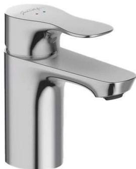
Cartouche à disques céramique. Raccords: Avec flexibles d'alimentation. Normes ACS. Débit: 5 l/mn, Saillie du bec: 98 mm. Fixation rapide 5/35.
