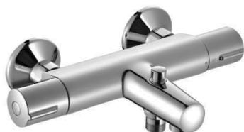
Economie d'eau : butée escamotable à mi-débit. Sécurité et économie d'énergie : blocage température maximum 50°, butée escamotable à 37°. Fonctionne avec un chauffe-eau à accumulation, instantané ou mixte d'au moins 18 kWh. Aérateur anti-calcaire. Clapet anti-retour sur les alimentations. Inverseur à bouton-poussoir basse pression.
