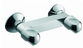
Poignées métal. Entraxe : 150 ± 15 mm. Débit : 14 l/mn sous 3 bars. Mécanisme : Têtes à disque en céramique (CD). Normes : NF : IA - ECAU : E1 A2 U3 - Qualitel 3. Vendu avec raccords et rosaces murales.
