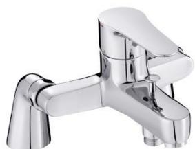
Mitigeur Métal 2 trous. NF : IC/A - ECAU : E3/1 C2 A2 U3 - Ge3. Débit : 20 l/mn sous 3 bar. Avec raccords colonnettes. Cartouche à disques céramique. Entraxe 150 mm. Avec Eco conso. Sans vidage. Installation sur baignoire. Inverseur : Automatique verrouillable. Garantie mécanisme : 5 ans. Aérateur anti-calcaire.
