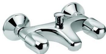
Entraxe : 150 ± 15 mm. Débit : 22/13 l/mn sous 3 bars. Mécanisme : Têtes à clapet ou à disque céramique (CD). Normes : NF : IB/A - ECAU : E3/1 A2 U3 - Qualitel 3. Vendu sans raccords.
