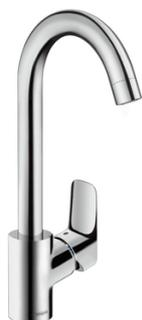
Caractéristiques · ComfortZone 260 · bec orientable possible sur 3 niveaux 110°, 150° ou 360° · jet normal · débit maximal à 3 bars: 12 l/min · cartouche céramique · limiteur de température réglable · convient au chauffe-eau instantané · comprenant: mitigeur de cuisine, flexibles de raccordement, set de fixation, notice de montage
