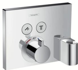
Utilisation simultanée de plusieurs sorties. Bouton Select marche/arrêt pour 2 sorties. Cartouche thermostatique SMTC, mécanisme Push marche/arrêt. Butée de confort à 40°C. Limiteur de température réglable. Débit : 29 l/min. Support de douchette intégré. Comprendant : poignée, rosace, douille, bloc de fonctions, touches, Fixfit et porter intégrés. Type de raccordement : corps d'encastrement.
