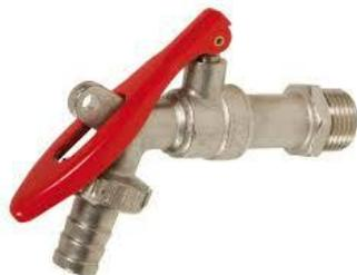
Utilisation de distribution d'eau - Raccord au nez. Brise jet incorporé - Axe injectable - Bille pleine - Etanchéité de l'axe par 2 joints toriques - Poignée acier. Cadenassable - PN16.
