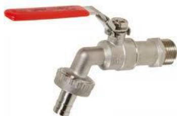
Industries chimiques et pharmaceutiques, industries pétro-chimiques, installations hydrauliques, air comprimé - Raccord au nez - Axe injectable - Bille pleine - Etanchéité de l'axe par 2 joints toriques NBR - Poignée inox - PN16 - Cadenassable.
