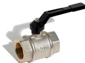
Corps en laiton CW617N. Sphère en laiton chromé CW617N. Passage intégral. Etanchéité à la tige par bague presse-étoupe en PTFE et joint torique en NBR. Raccordement F-F. Poignée aluminium noire. Utilisation : Eau, air comprimé à 10 b. maxi. P. maxi : 65 b. T° : -20° à +120°C.
