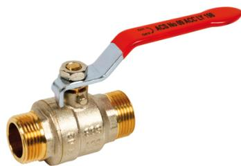
Passage intégral. Presse étoupe en PTFE (120°C). Laiton titré conforme Norme Européenne EN12165. Manette plate. Traçabilité (logo-date de fabrication). ACS et conforme 4MS.
