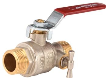
Passage intégral. Presse étoupe en PTFE (120°C). Laiton titré conforme Norme Européenne EN12165. Manette plate. Traçabilité (logo-date de fabrication). ACS.
