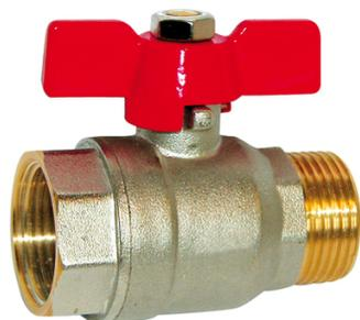
Passage intégral. Presse étoupe en PTFE (120°C). Laiton titré conforme Norme Européenne EN12165. Manette papillon. Traçabilité (logo-date de fabrication). ACS et conforme 4MS.
