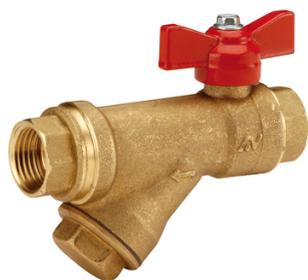
Dimensions : DN1/2 à DN11/4 Raccordement : Femelle BSP Température Mini : -10°C Température Maxi : +110°C Pression Maxi : 16 Bars Caractéristiques : Axe inéjectable Tamis inox démontable Filtration 500 (5/10°) Matière : Corps laiton CW617N suivant EN 12165"
