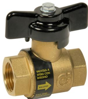
Dimensions : DN1/2 à DN2. Raccordement : Femelle BSP. Température Mini : +5°C. Température Maxi : +90°C. Pression Maxi : 16 Bars. Clapet anti-retour intégré. Toutes positions. Obturateur Nylon. Joint NBR. Corps laiton CW617N-4MS suivant EN 12165.
