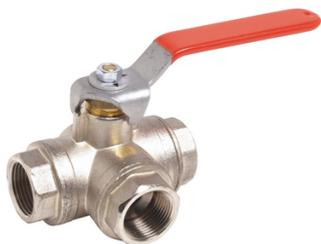
Ouverture droite ou gauche. Corps laiton. Poignée acier. Pour fluides courants compatibles. Température mini/maxi : -10°C/+120°C. Pression maxi admissible Ps : 16 bar. Pression différentielle 5 bar maxinde.
