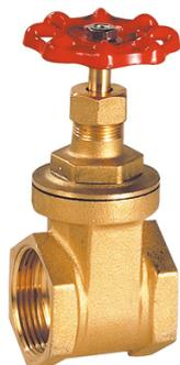
Série 102. Vannes à opercule. Corps laiton. PN16. Taraudée BSP. Corps laiton. Opercule laiton. Joints d'axe NBR. Passage réduit. Tige tournante non montante. Tige à filetage intérieur. Volant rouge aluminium jusqu'au DN 1?1/2 et fonte au-delà.
