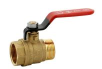
Dimensions : DN 3/8 à DN 2. Raccordement : Femelle BSP. Température Mini :-10°C. Température Maxi:+110°C. Pression Maxi:16 Bars. Axe inéjectable. Tamis inox démontable. Filtration 500 (5/10°). Corps laiton CW617N suivant EN 12165.
