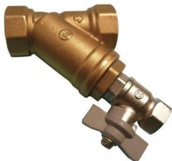
Filtre à tamis en Y laiton 4MS avec robinet de rinçage laiton pour les réseaux d'adduction et de distribution d'eau. Le robinet de rinçage permet d'évacuer les impuretés. Filtration 850µ avec tamis en inox 304. L'étanchéité est assurée par un joint torique EPDM. Compatible avec les réseaux d'eau potable grâce à l'attestation de conformité sanitaire (ACS).
