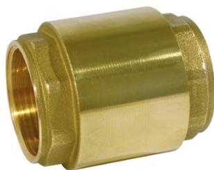
Clapet de non-retour ACS à double guidage laiton pour les réseaux d'eau potable, chauffage, eau froide et eau chaude. Le corps est en laiton CW617N-4MS, l'obturateur est en nylon et l'étanchéité est assurée par un joint plat NBR garantissant une excellente étanchéité haute / basse pression. Système à double guidage axial et latéral assurant un centrage parfait de l'obturateur sur le siège. Le ressort de rappel en inox 304 permettant un montage toutes positions.
